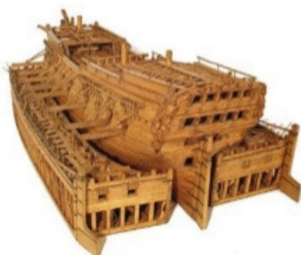
Model van een VOC-schip met langs zij twee scheepskamelen. Dit waren grote houten pontons, die BB en SB tegen het zeeschip werden aangesjord. Ze hadden een uitholling opzij, waar de romp van een zeeschip rowweg in paste.
